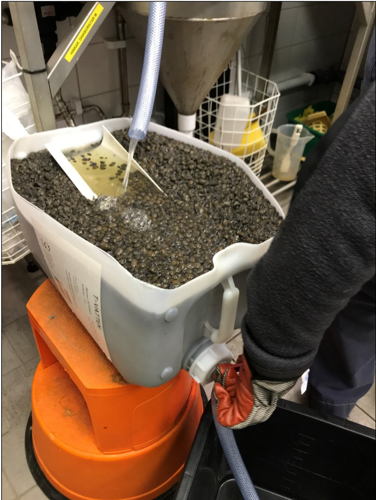
Foto 4. Hängrännan sjönk som Titanic när vattennivån steg i leca-materialet!
