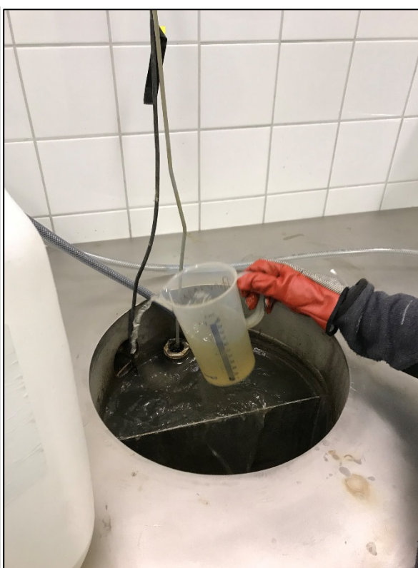
Foto 1 och 2. Vatten togs ut provtagningspunkt för inkommande vatten till ARV och fylldes i "den övre dunken".
