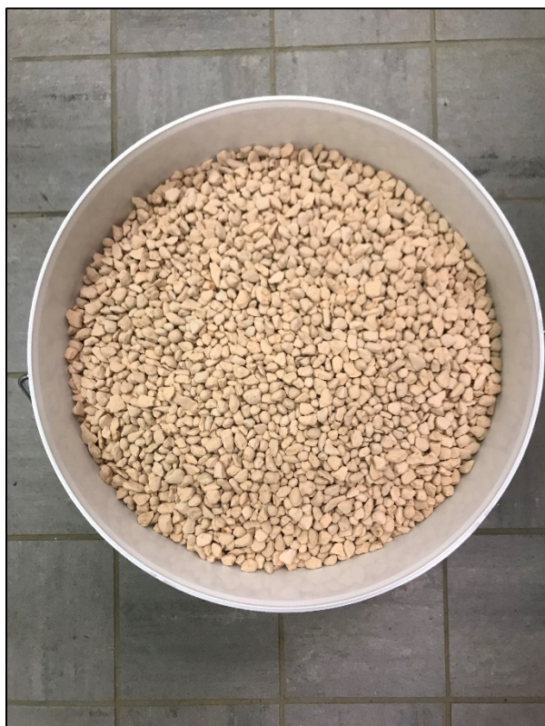
Foto 1 (t vä) Polonitematerialet, och 2 (t hö) Flockarna i vattenfasen ovanför Polonitematerialet.
