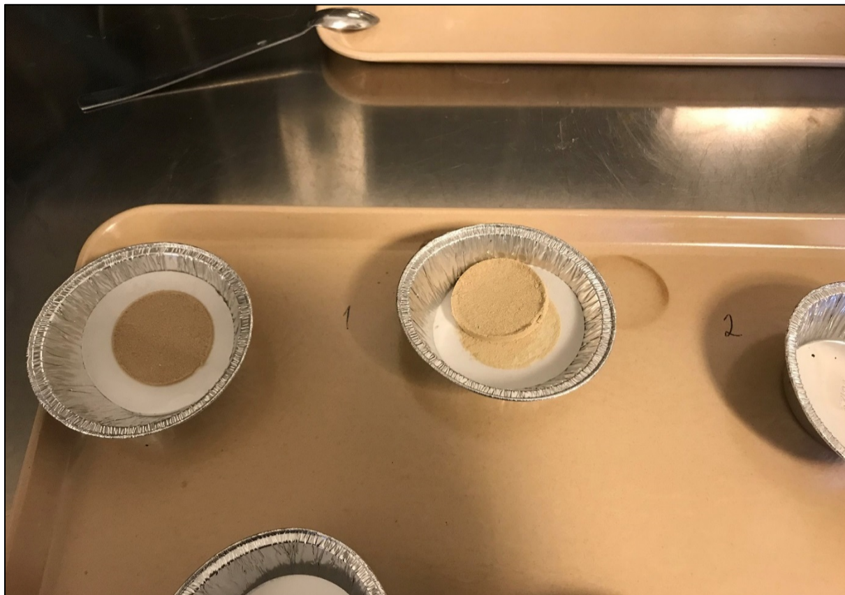
Foto 6: Det följde med så mycket minerogena partiklar från Poloniten så att det bildades "kakor" på filtren vid vacuumfiltreringen.
