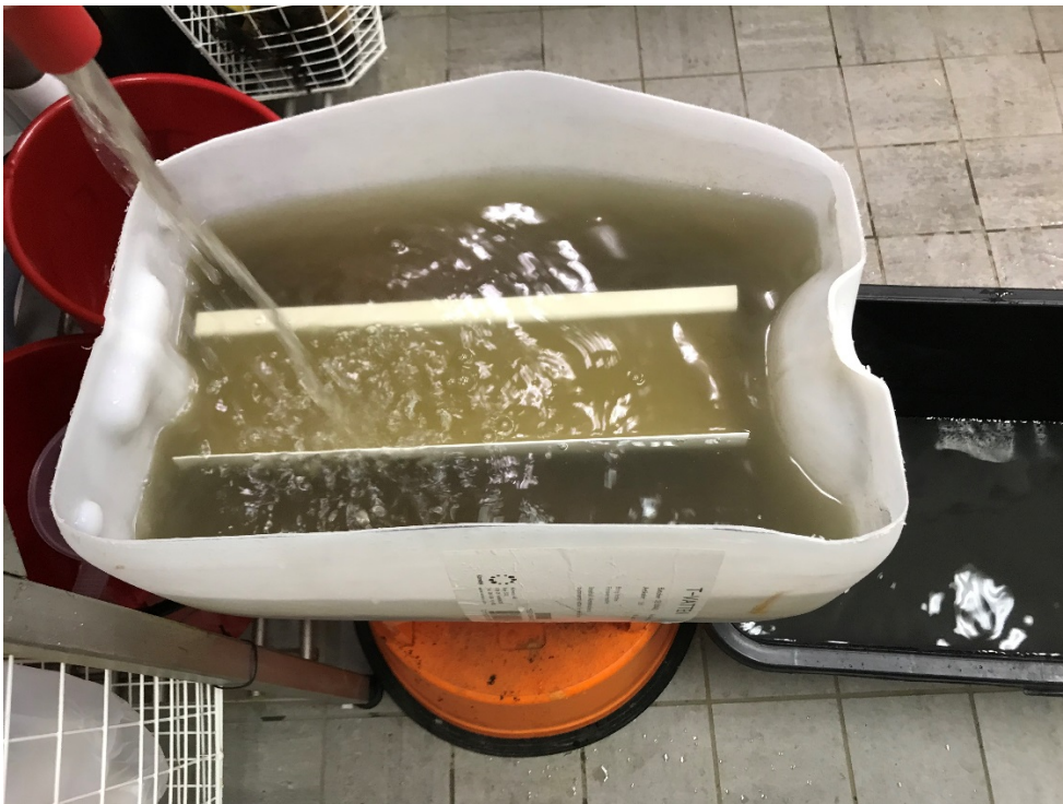
Foto 2. Nedre dunken med Polonitematerialet, samt med hänggränsan med hål för spridning av vattnet över materialet.
