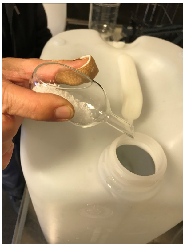
Foto 1: 2,00 gram polyetenfluff tillsattes i 10 l vatten.
