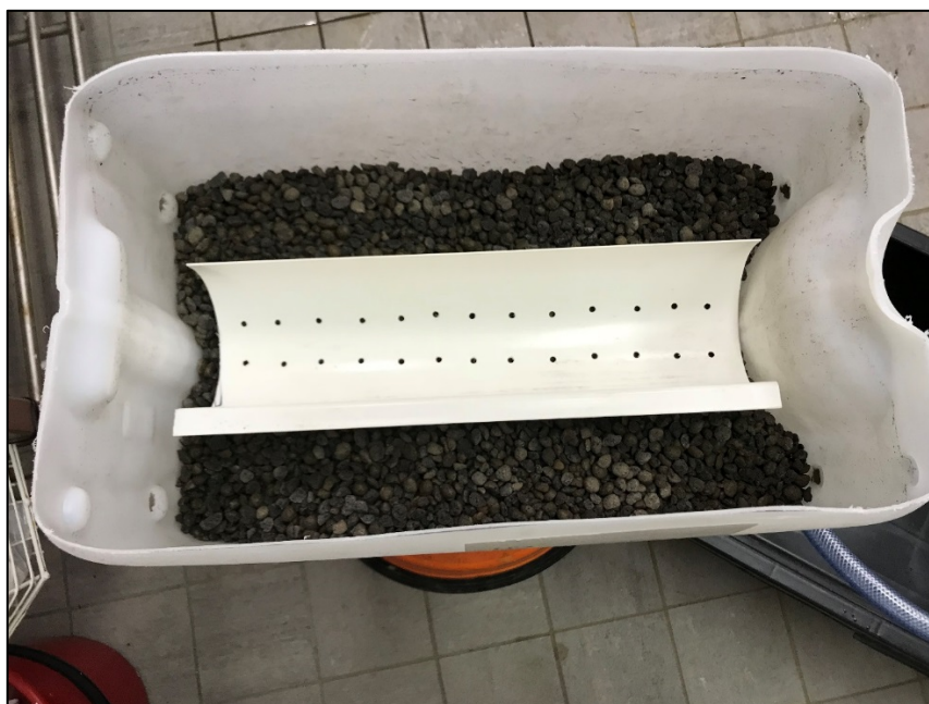
Foto 3. Nedre dunken med samma material som vid testkörningen 2018-02-05, samt med hänggränsen med hål för spridning av vattnet över leca-materialet.
