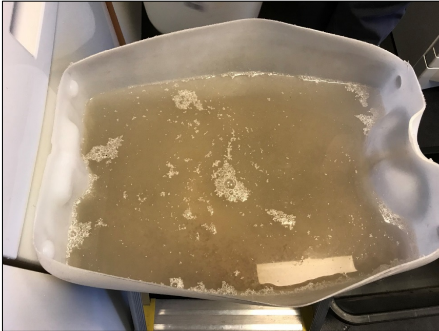
Foto 3: Fluffen flöt omkring på vattenytan i den nedre dunken, med Poloniten.
