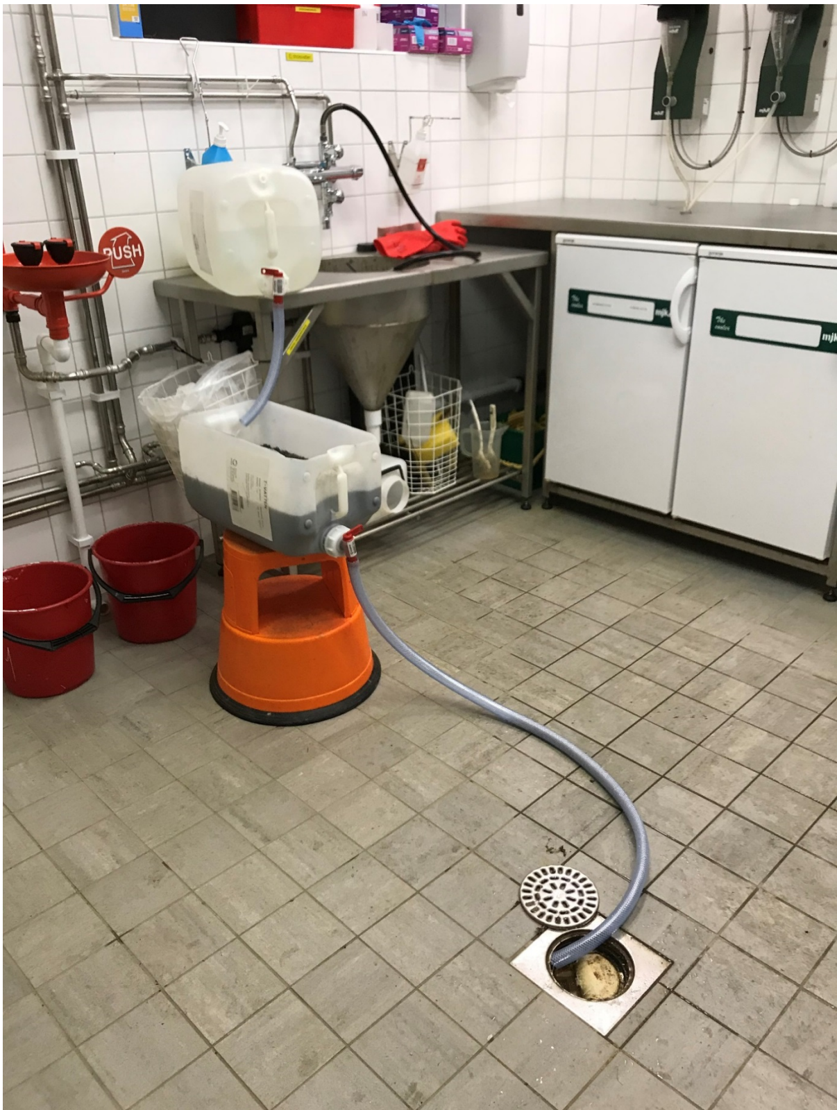
Foto 2 Uppställningen med leca-material i den nedre dunken och spolning med kranvatten.
