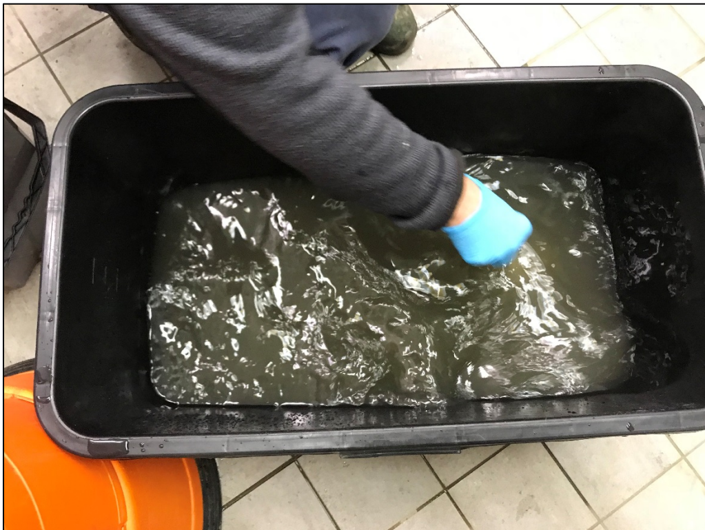
Foto 7. Omrörning inför provuttag "UTG 2". Omblandat i baljan.
