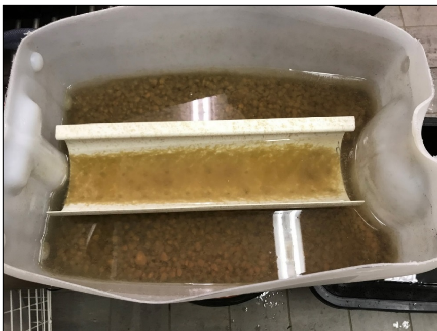
Foto 3. Nedre dunken med Polonitematerialet, samt med hänggränsan med hål för spridning av vattnet över materialet.
