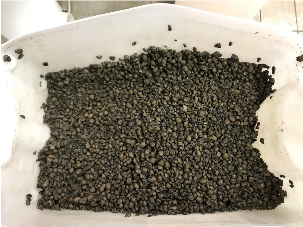
Foto 3 Leca-materialet efter tredje spolningen med kranvatten och efter att vattnet sjunkit undan.
