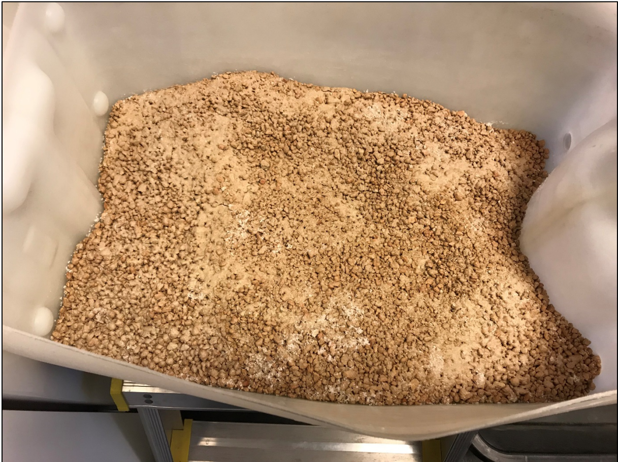
Foto 7: När vattnet sjönk undan stannade en stor mängd av fluffen kvar på ytan av Poloniten.
