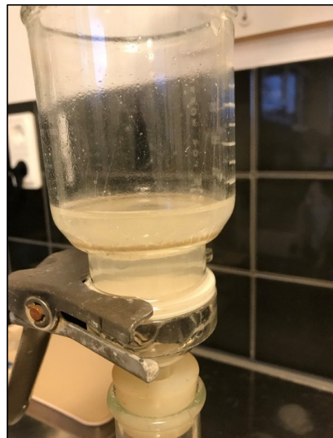
Foto 4 (t vä): Polonitens småpartiklar följde med vattnet ut genom kranen och ner i bägaren.
