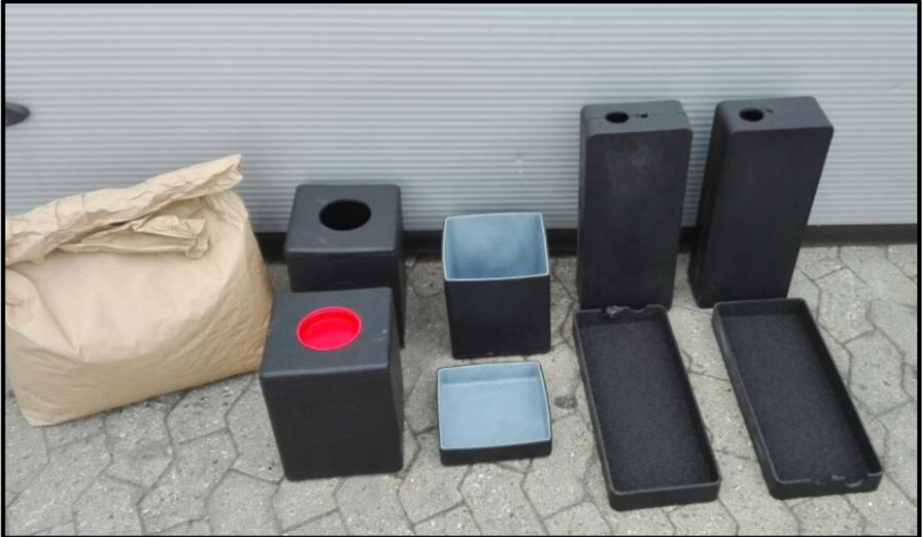
Formtest af havplastpulver hos Dansk Rotationsplast
