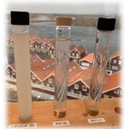
Processvatten i olika reningssteg, i sista steget renare än själva havsvattnet
