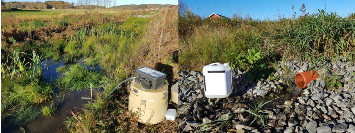
Figur 7. Provtagningspunkt D (t.v.) med en automatisk sekventiell vattenprovtagare med kapacitet på 24 1-liters provflaskor som ryms i provtagarens undre del och som fylldes automatisk under försökets 6 timmar, d.v.s. ett prov (på en liter) var 15:e minut. Utloppet från hela anläggningen (provtagningspunkt E) på den högra bilden. Foto: IVL.
