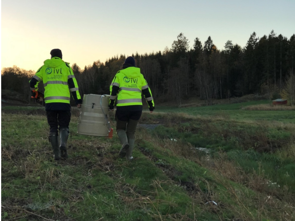
Figur 6. Utplacering av en automatisk sekventiell vattenprovtagare med kapacitet på 24 enskilda 1-liters prover. Foto: Kungälv kommun, se mer och även film om testet på: www.kungalv.se/vamikroplast
