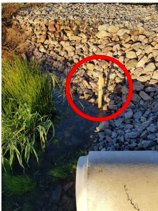
Figur 3. Trästav som fixpunkt för mätning av vattennivå. Foto: IVL.
